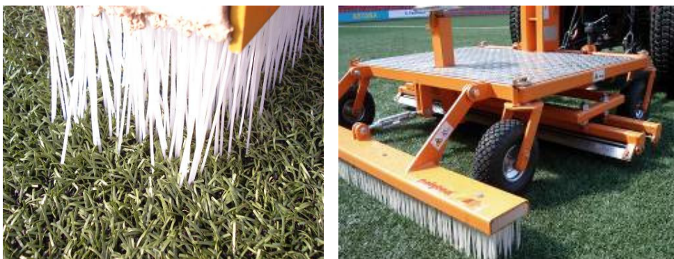
Kunststoffbürste am ACS Gerät
