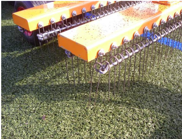
Nadelbalken am Polytan ACS 210 Gerät
