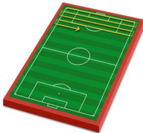
Fahrwege bei gegenläufiger Verlegung gegen die Strichrichtung
